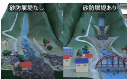
土石流模型実験装置による砂防施設の効果の実験
