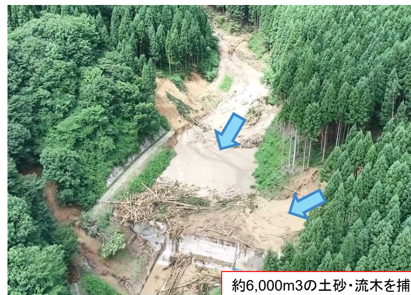
土石流発生直後 (R4.8.4撮影)
