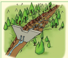
④堰堤に貯まった岩、土砂や流木は、次の土石流に備えて取り除きます。
