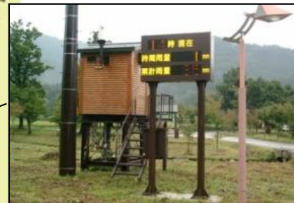
荒川流路工に隣接して整備されているオートキャンプ場等の観光施設内に雨量情報表示盤を設置
