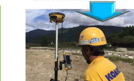
施工後のGNSSローバーによる高さ確認
