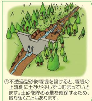
②不透過型砂防堰堤を設けると、堰堤の上流側に土砂が少しずつ貯まっています。土砂を貯める量を確保するため、取り除くこともあります。
