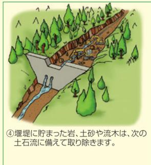
④堰堤に貯まった岩、土砂や流木は、次の土石流に備えて取り除きます。
