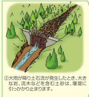
③大雨が降り土石流が発生したとき、大きな岩、流木などを含む土砂は、堰堤に引っかかり止まります。
