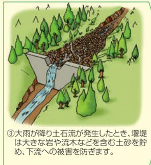
③大雨が降り土石流が発生したとき、堰堤は大きな岩や流木などを含む土砂を貯め、下流への被害を防ぎます。
