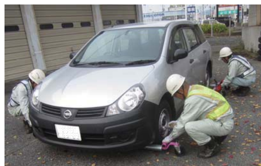
車両移動用機械設置状況
