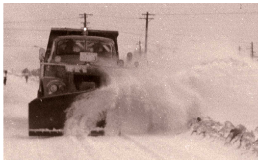
排雪板を装着した ダンプトラック
