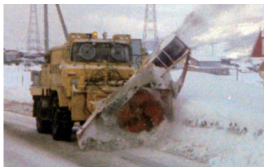
高速除雪を目的とした 高速大型ロータリ 除雪車(800馬力級)
