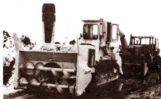
ブルドーザに改造を加えた ロータリ除雪車
