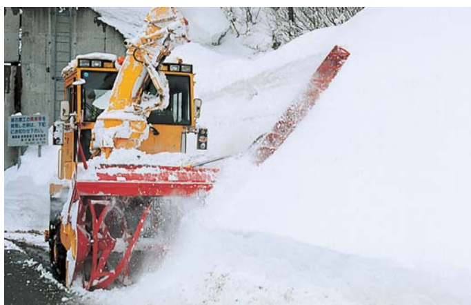
ロータリ除雪車による作業
