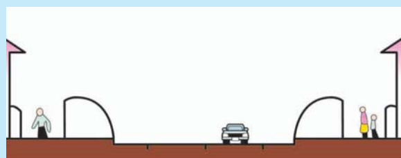
除雪された歩道
