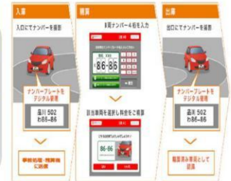
ゲートレス車番入出庫管理システム
