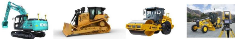
バックホウ ブルドーザ 振動ローラ モータグレーダ
