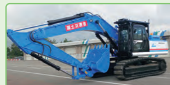
えんかくそうじゆうたいおうがた 遠隔操縦対応型バックホウ
