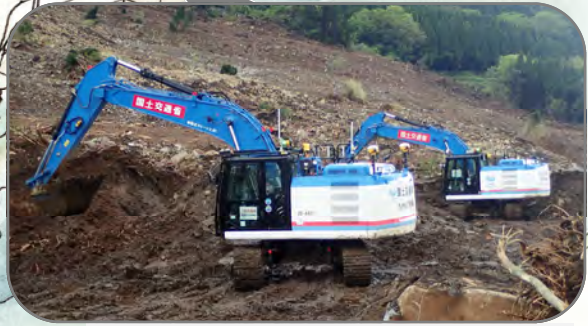
■遠隔操縦対応型バックホウ 人が立ち入ることのできない危険な場所でも災害復旧活動を行えるよう、人が乗らなくても操縦できる油圧ショベルです。
