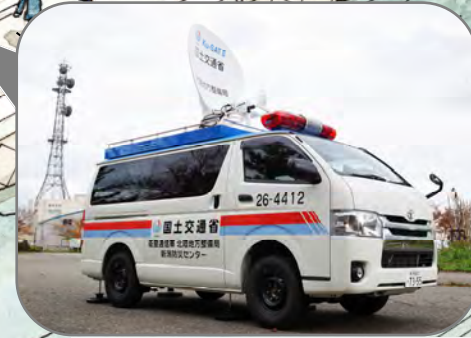
■衛星通信車 災害で通信回線が不通の場合に災害現場と対策本部間の衛星を使用した通信回線を確保するために使用します。
