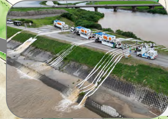
■排水ポンプ車 排水作業を行うために使用します。照明車を使用すれば、ポンプの設置作業が夜間でも迅速に行うことができます。
