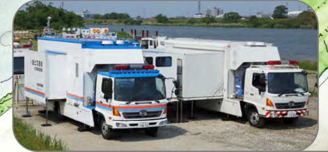
■対策本部車 災害現場の対策本部として使用します。衛星電話、FAX、テレビ、ビデオが装備されています。
