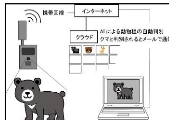
【クマ侵入対策システムの監視方法】
