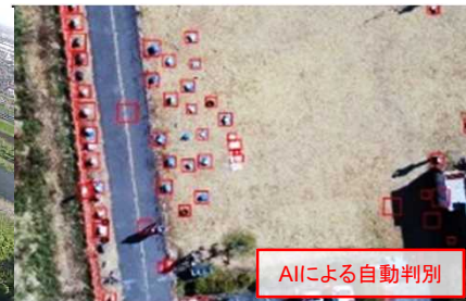
▼3次元データによる河道全体の把握 ▼ドローンの自律飛行による河川巡視 ▼ドローン撮影画像からAIによる異常確認
