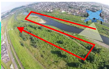
▼3次元データによる河道全体の把握 ▼ドローンの自律飛行による河川巡視 ▼ドローン撮影画像からAIによる異常確認
