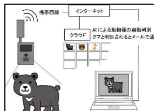
【クマ侵入対策システムの監視方法】
