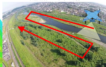
▼3次元データによる河道全体の把握 ▼ドローンの自律飛行による河川巡視
