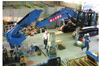
分解組立型遠隔操縦式バックホウ納入時の組立状況（平成26年3月）
