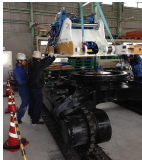
分解組立型遠隔操縦式バックホウ納入時の組立状況（平成26年3月）
