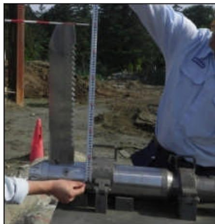
写真-4 地中拡翼型攪拌翼（拡径時）
