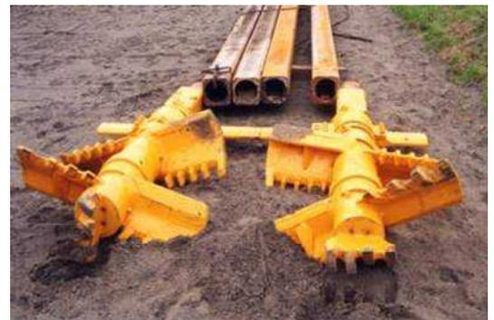
写真-2 DJM 工法 攪拌翼
