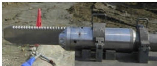
写真-3 地中拡翼型攪拌翼（縮径時）
