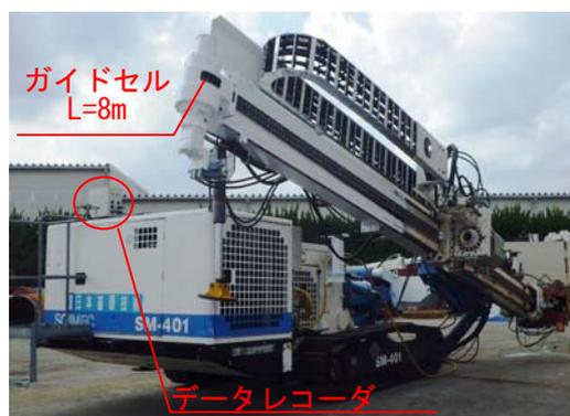
写真-1 水圧ハンマ搭載削孔マシン
