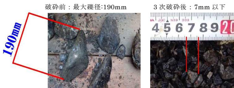
写真-4 礫の破砕状況写真
