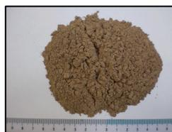
写真－1 安定化処理後下水汚泥焼却灰
