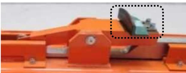
写真-1 インナー支持装置（塩ビ管設置前）
