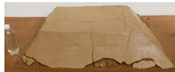
図-6 安定処理土の模擬堤防クラック状況
