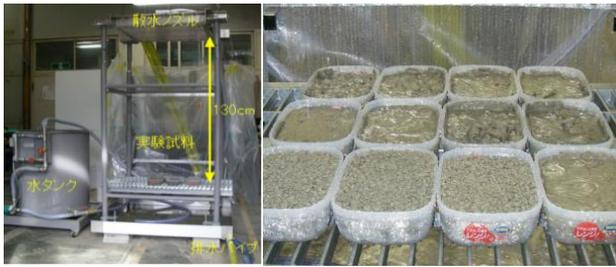
図-8 人工降雨機および試料状況
