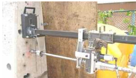
写真 - 2 WJ 削孔装置
