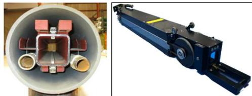
写真-3 インナー装置と自走式計測ロボット
