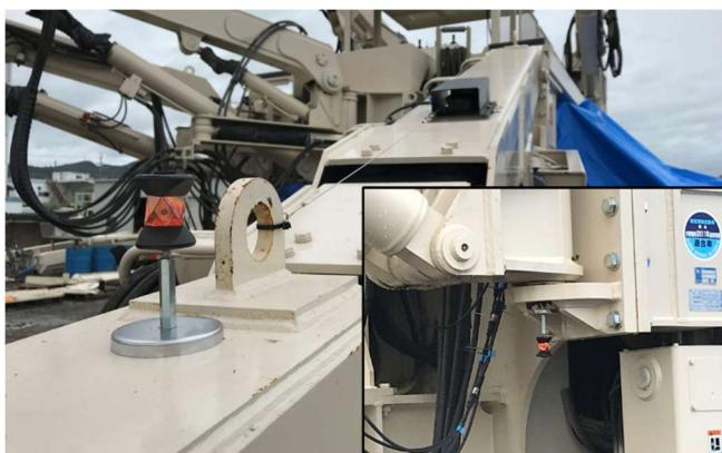
写真-3 たわみ計測用プリズム
