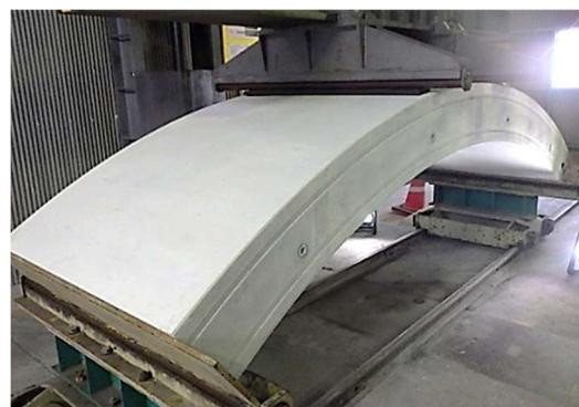
写真4 セメント・ゼロ型を用いたセグメントの例
