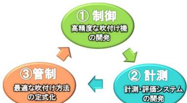
図-2 自動吹付けに必要な3つの機能
