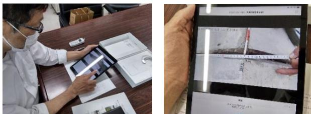
図-2 タブレットを用いた遠隔臨場
