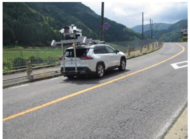
写真-1 MMS による計測状況
