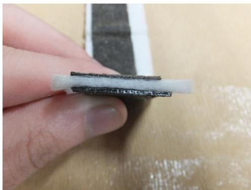
図-1 導水テープの構造断面
