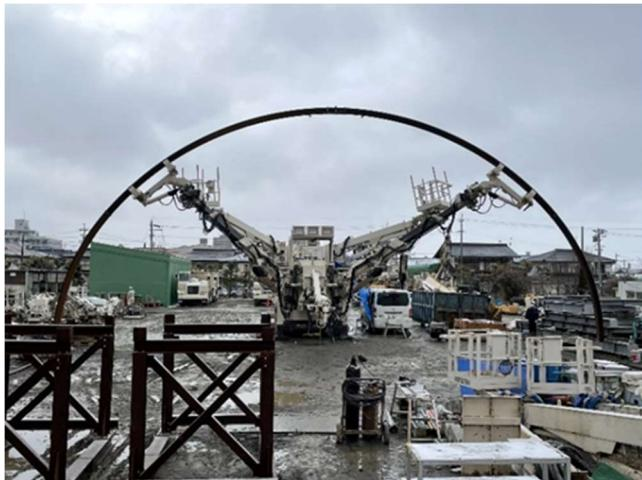
写真-1 完全自動鋼製支保工建込ロボット
