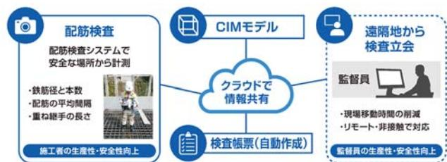
図-5 3眼カメラによる配筋システム概要
