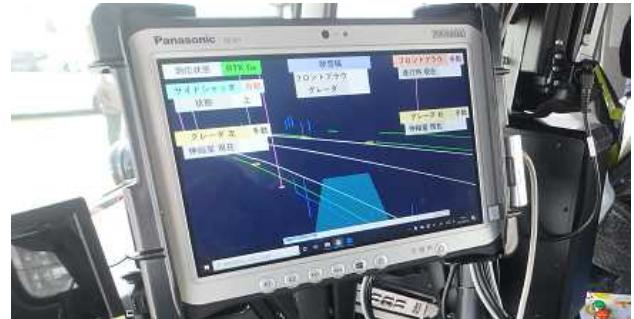
写真-2 自動操作制御装置
