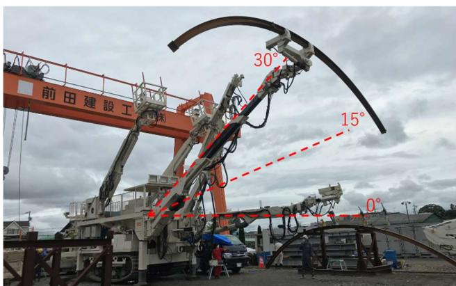
写真-4 たわみ試験の様子（鉛直上向き  $30^\circ$ ）
