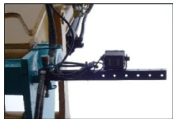
図（写真）－7 把持装置に設置されているカメラ
