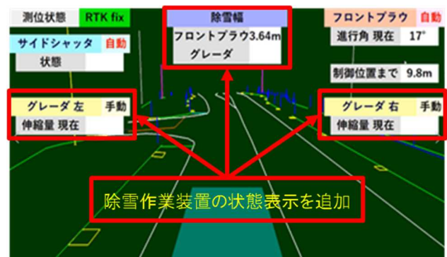
図-6 自動操作制御装置の表示画面例
