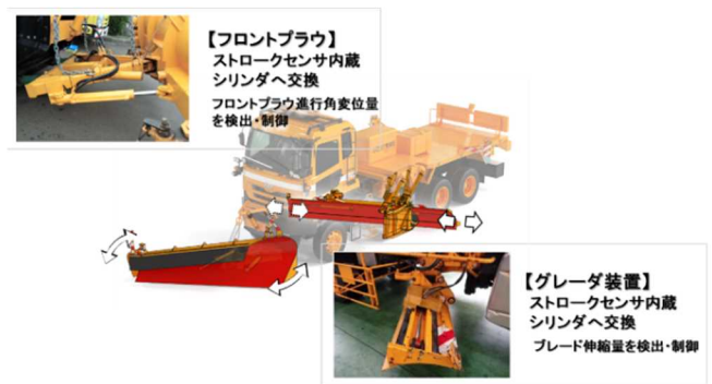
図-5 除雪トラック試験機改良箇所
