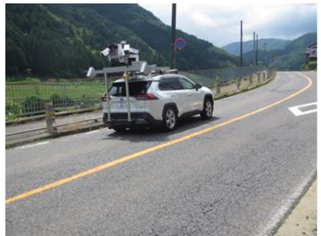
写真-1 MMS による計測状況
