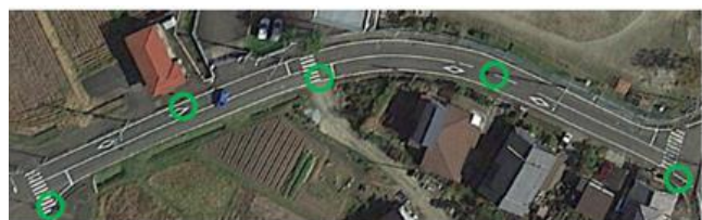
写真-2 TS による標定点設置状況 ステップ 2 (MMS 計測)
