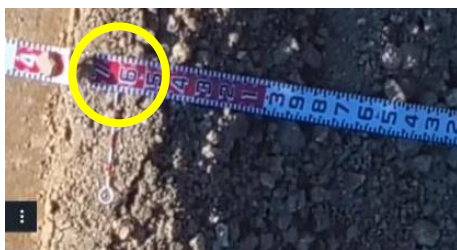
図-7 リボンロッド 1cm ピッチ視認(モニター)
