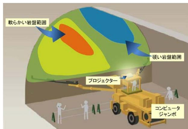
図-4 岩盤硬軟コンターの投影イメージ
