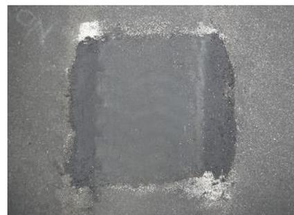
写真-5 走行試験後の補修箇所の様子
