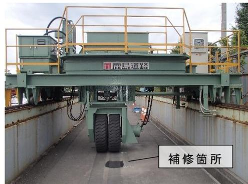
写真-4 ロードシミュレータの外観
