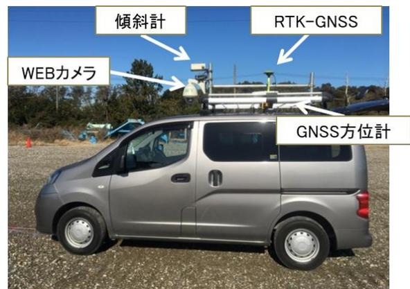
写真-1 車両への機材設置状況
