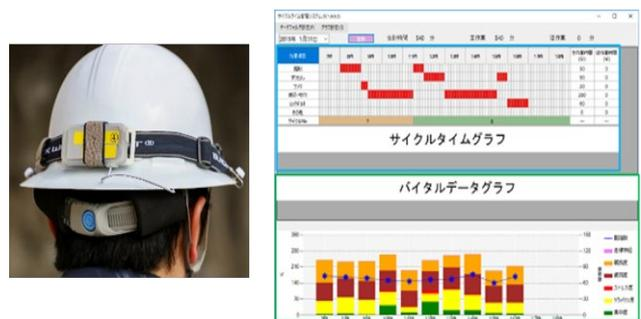
図-5 圧電センサーとバイタルデータ分析
