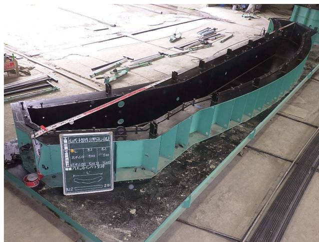
写真-2 鋼製型枠
