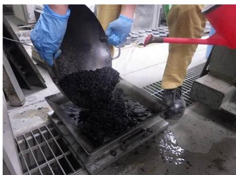
写真-2 中和反応型常温の供試体作製状況
