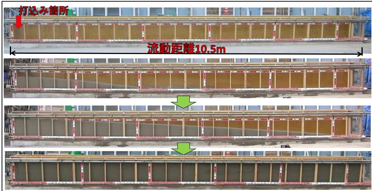
写真-4 流動実験でのニューロクリート Neo の流動状況
