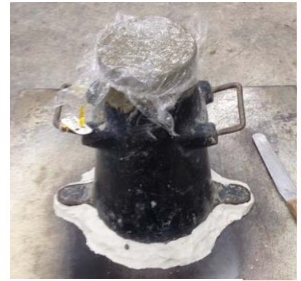
写真-4 静置スランプ試験 試験状況
