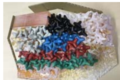
図-1 3D プリンタ模型(既設)への嵩上げ
