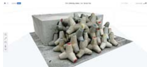
図-3 ブロック模型を用いた消波工の 3D モデリング結果（サーフェスモデル）
