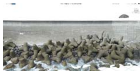
図-6 消波工の 3D モデリング結果 (サーフェスモデル)
