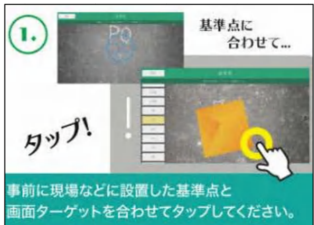
写真-2 TS方式による配置手順
