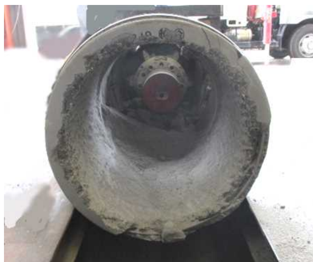
写真-4 コンクリート管切削状況
