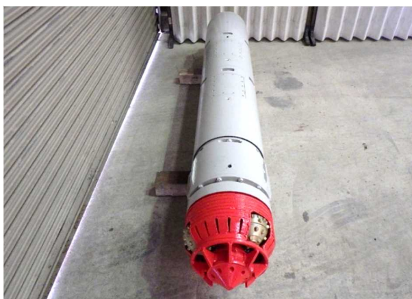
写真-3 後方掘進機
