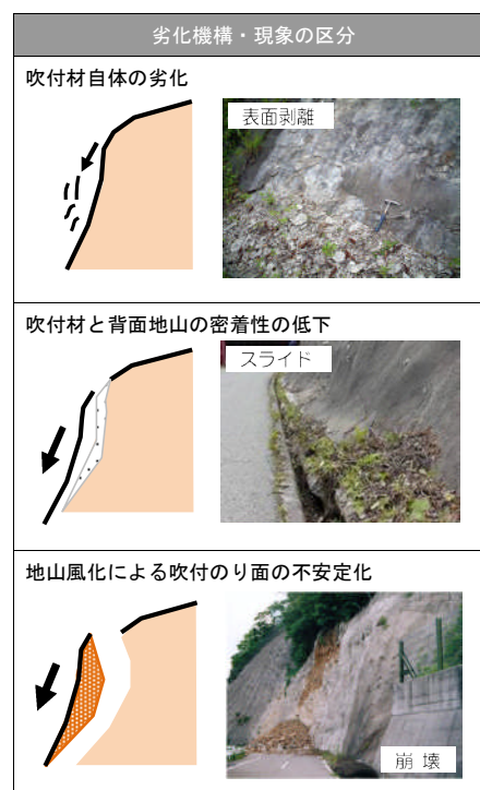
図-1 吹付のり面の劣化機構・現象区
