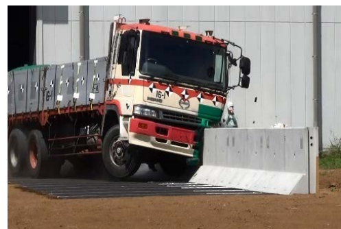
写真-2 実車衝突実験
