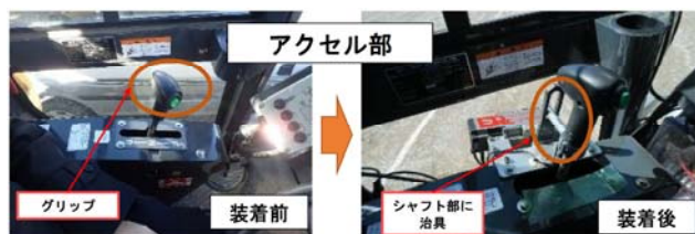
図-7 アクセル部のロボット機構
