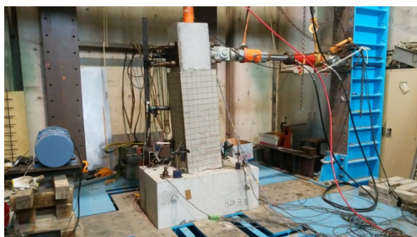
写真-3 正負交番繰り返し載荷試験の状況
