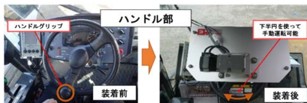
図-6 ハンドル部のロボット機構
