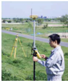
写真-3 RTK-GNSSを使用して受信状況を確認
