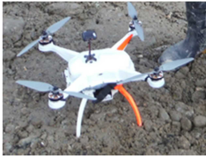
写真-2 本工事で使用したUAV
