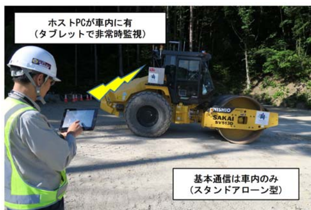
図-9 一般工事仕様の全体システム
