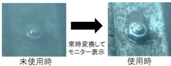
図-3 画像詳細強化装置による効果
