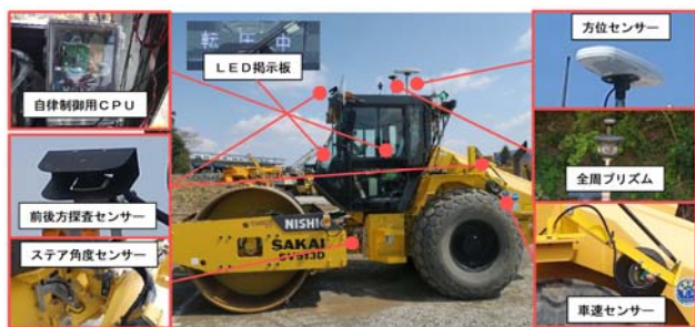
図-4 センサー搭載状況
