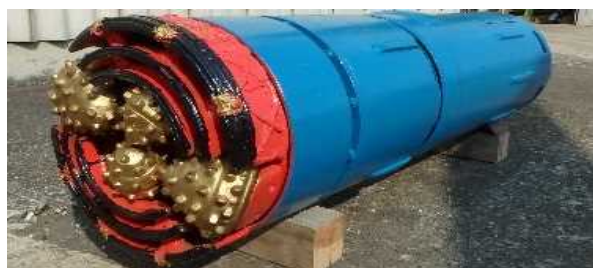
写真－2 礫対応掘進機
