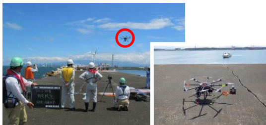
写真－1 UAV（ドローン）による航空測量
