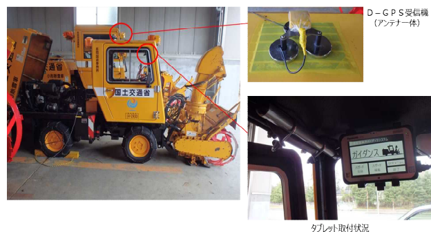
写真-2 取付状況
