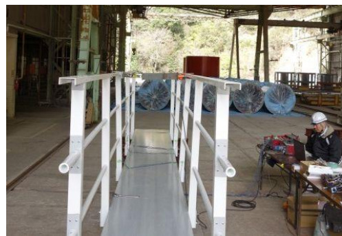
写真-4 手摺の静的載荷試験（水平）
