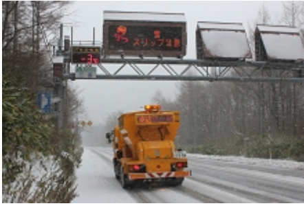
路面への定着性を向上させた 湿潤式凍結防止剤散布車
