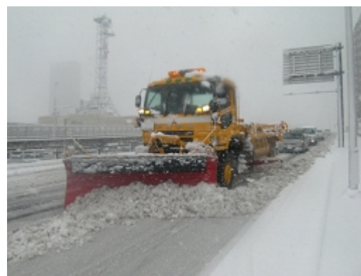
路面状況を検知して押付圧力を自動制御するオートマチック式の除雪トラック
