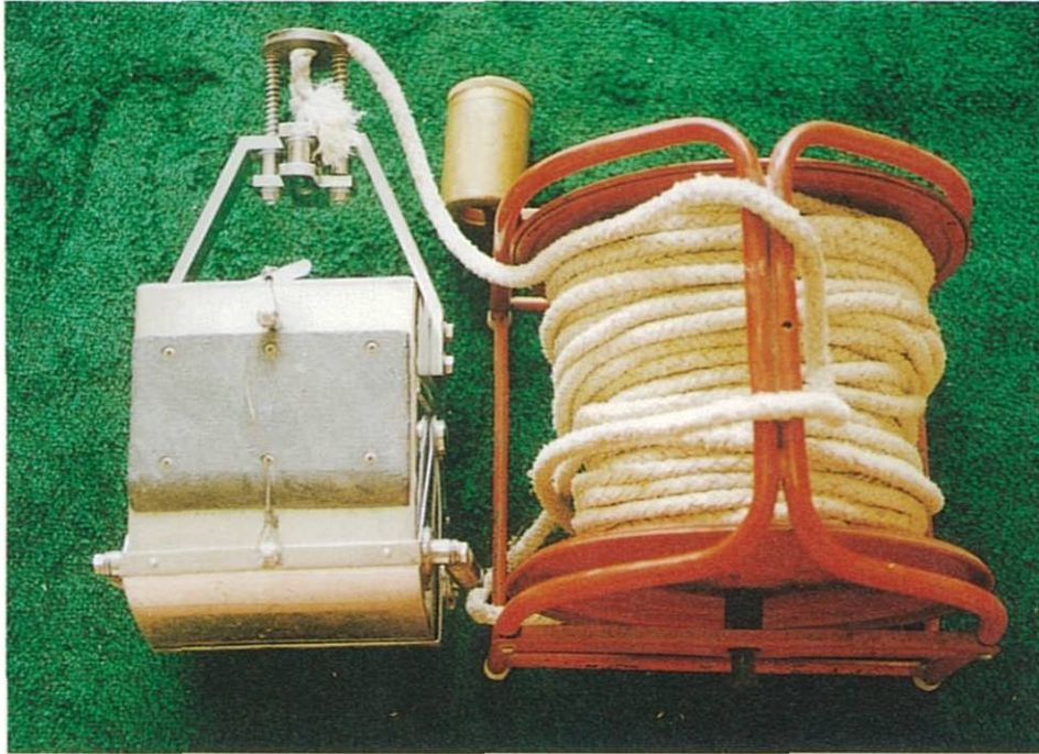
【写真-24】 エックマンバージ採泥器
