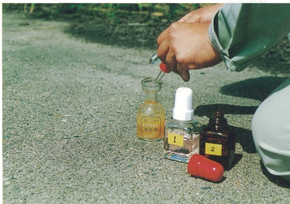
【写真-23】 溶存酸素の固定
