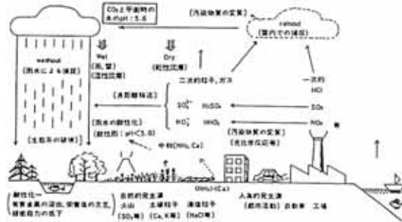
図 - 24 酸性雨のメカニズム (出典：玉置元則 環境技術 Vol.27 No.5, 1998)
