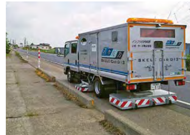
路面下空洞探査車で、路面陥没の原因となる空洞の有無を調査
