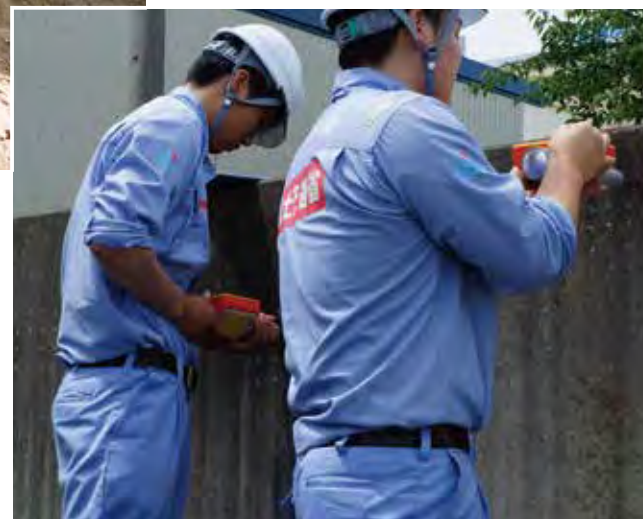
コンクリートを壊さずに強度を測定する方法を学ぶ(非破壊試験を体験)
