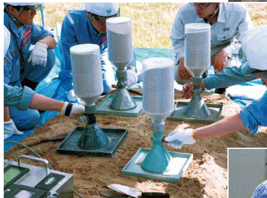
原位置の土の密度を求める試験を学ぶ(土質の試験)
