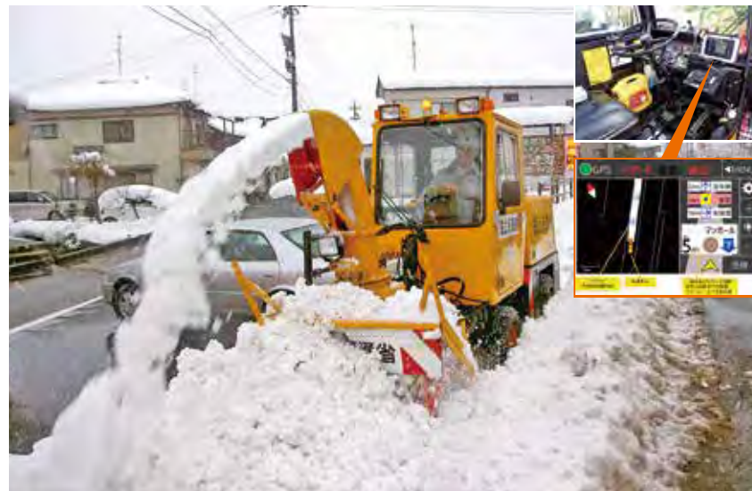
作業ガイダンス装置付きの歩道除雪車
