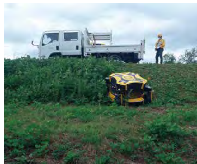
ウインチ付自走式除草機械により、作業効率、安全性が向上
