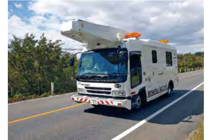
路面性状測定車で、長期保証型舗装工事や試験舗装箇所等の路面性状（わだち掘れ、ひび割れ、平坦性）を測定
