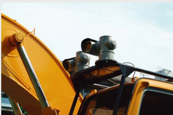
カメラ取付状況
