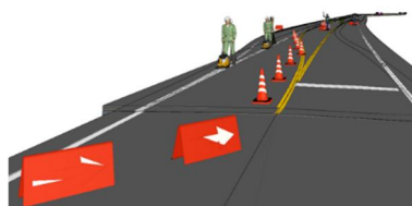
県道迂回路切替作業 CIM モデル
