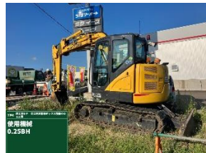
後方監視カメラ・緊急停止装置付きバックホウ
