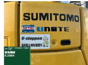
後方監視カメラ・緊急停止装置付きバックホウ
