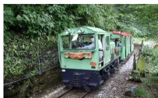
工事専用軌道
