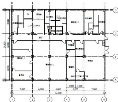
平面図 (総合のBIMデータを用いて作成)
