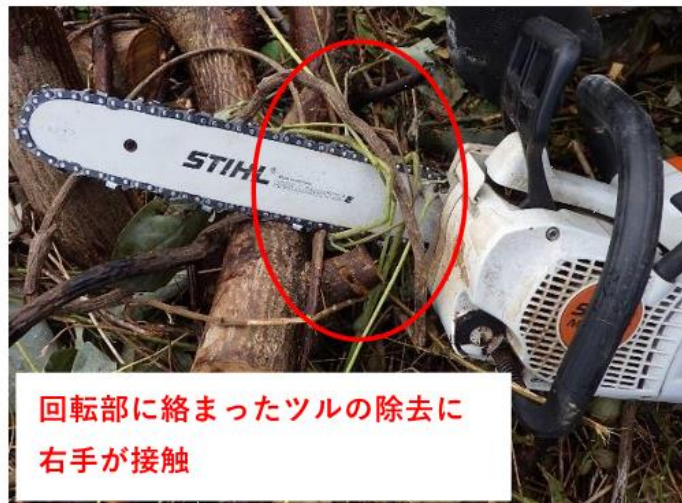
現場状況写真
