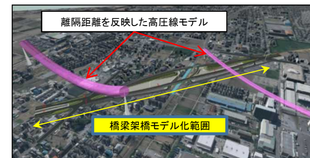
橋梁と架空線の離隔確認
