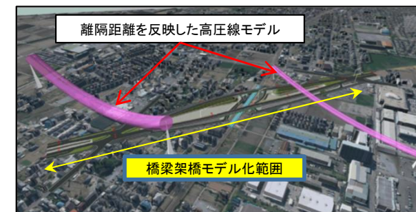
橋梁と架空線の離隔確認
