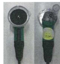
集塵カバーを取り付けてある正規の状態
