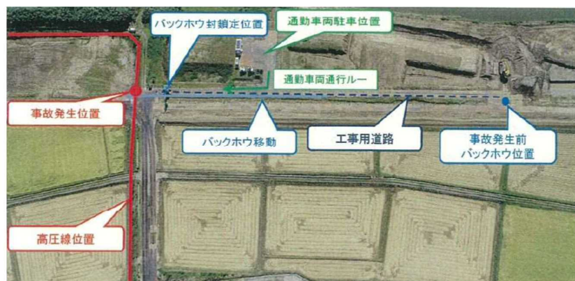
現場出入口を封鎖するため移動
