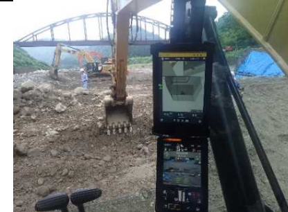
【実演】MCバックホウ操作(松本砂防)
