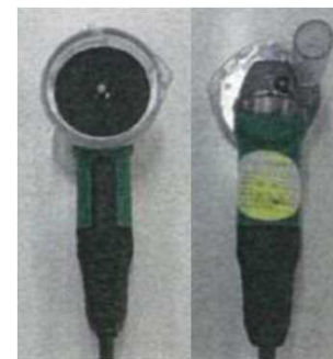
集塵カバーを取り付けた正規の状態
