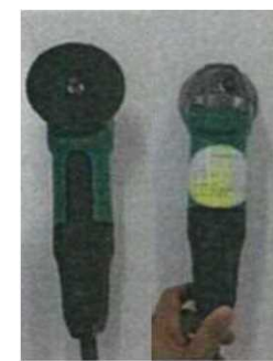
集塵カバー取り外した状態
