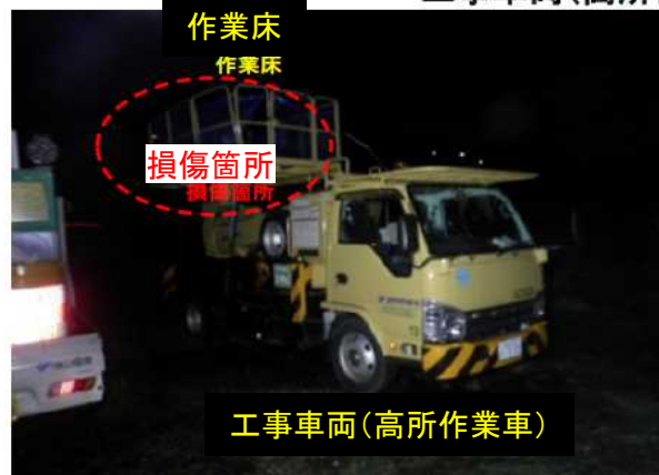
工事車両(高所作業車) 損傷状況(10/8撮影)
