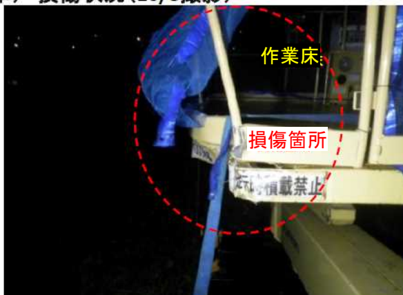
工事車両(高所作業車) 損傷状況(10/8撮影)
