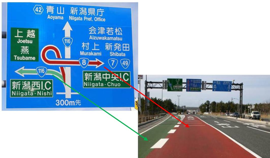
図 12.39 108 系標識で行き先方面（国道 8 号と国道 116 号）を色彩で明確化した例
