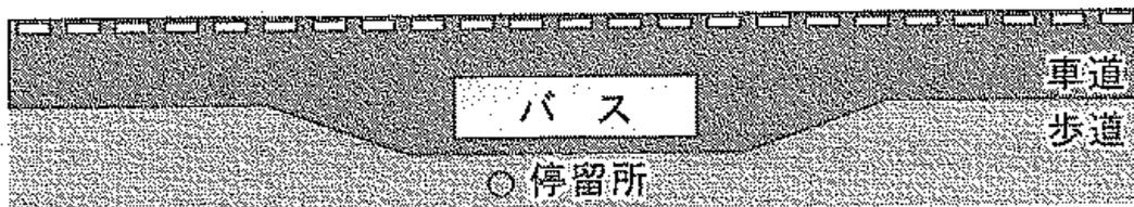
図 12.28 バスベイ型の構造
