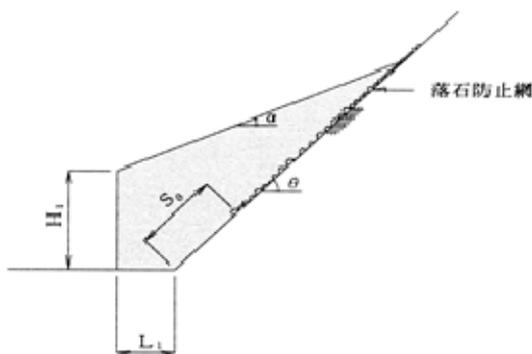
図11.55 落石防護網の端末
